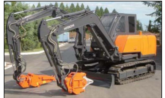
未来型機械: 双腕作業機ASTACO
